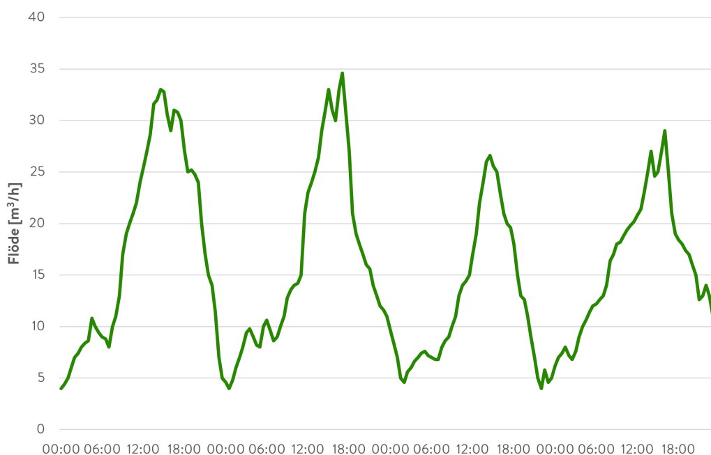
Figur 3. Exempel på fjärrkylflöde som varierar under dygnet (med effektuttaget).
